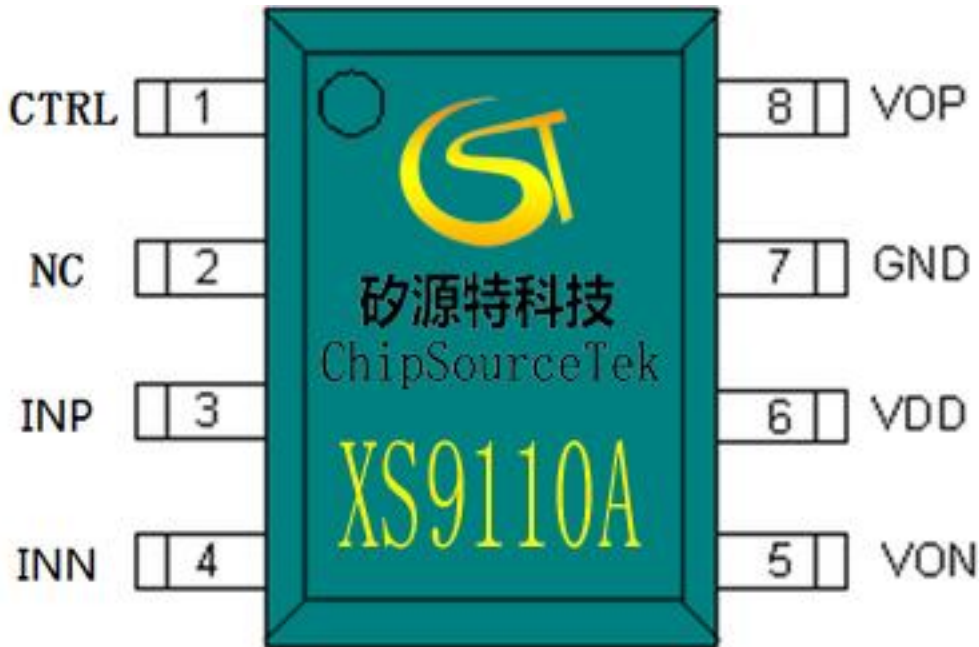
图 2 XS9110A 管脚定义
