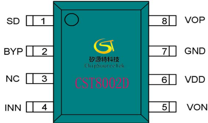
图2 CST8002D 管脚定义
